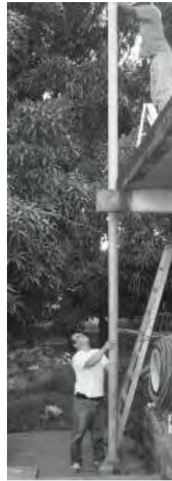
Izq: Ensayo de Impacto (altura 6 m); Der: Ensayo erosión por goteo (altura 1,50 m)
